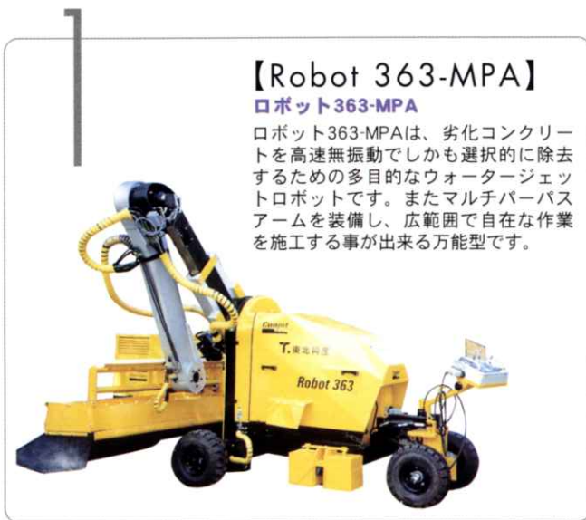
ロボット363マルチパーパスアームは、自在な作動範囲の施工を可能にします。
