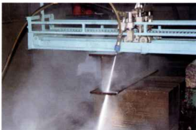
H鋼切断試験
